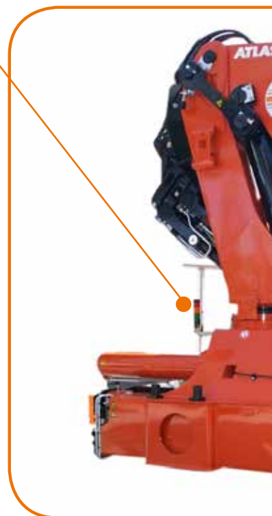
Greiferkopfstück, schnell montierbar. Quickly mountable grab head piece.
